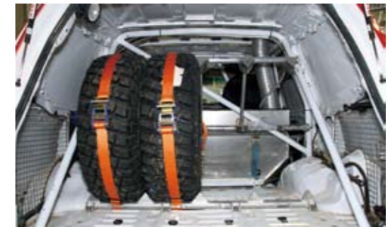
ロールゲージで補強される車体後部には4本のスペアタイヤを取納
