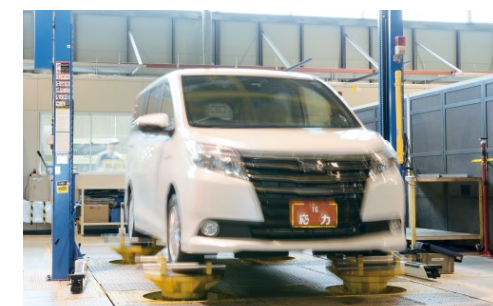
ベンチ耐久試験 A bench endurance test
