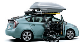
フレンドマチック取付用専用車 (ウェルキャリー付) Friendmatic Vehicle For After Market Accomodation (with "Wel Carry")
